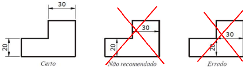
Figura I.5. Forma correta de cotação da peça.
