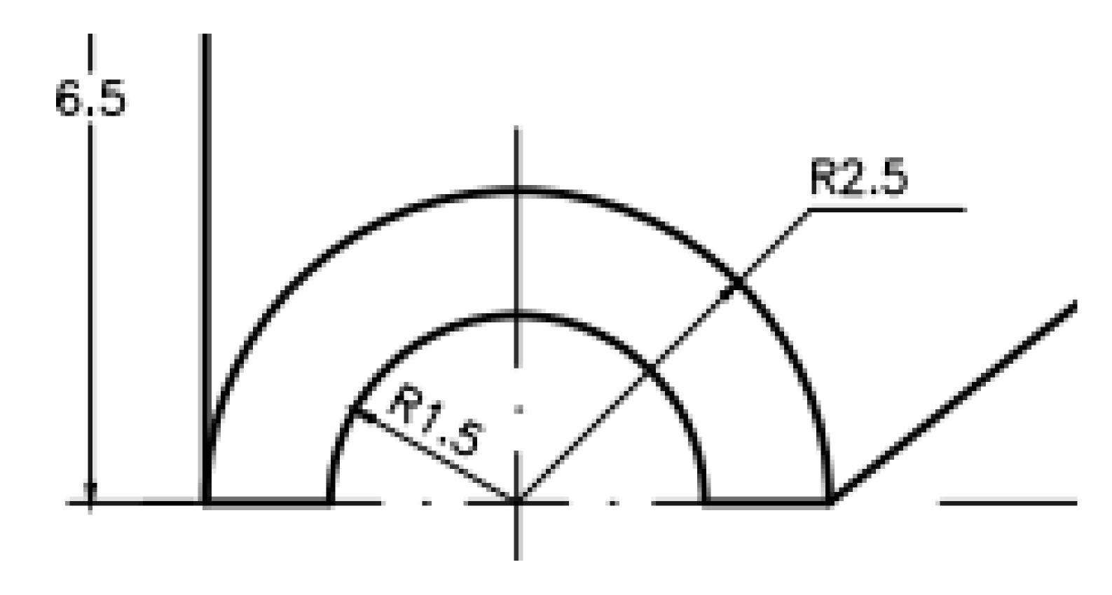
Percebam que o raio foi representado no arco e o diâmetro na circunferência (coloquem o cículo com o traço, notação do diâmetro, antes da numeração)
